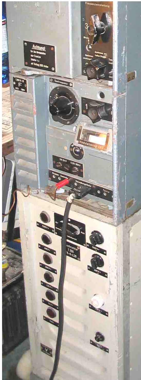
Tast und Modulator-Stufe van de T200 FK39a Geplaatst op voeding T200 FK – K – L 39 Module Y AEG serienummer 199229
